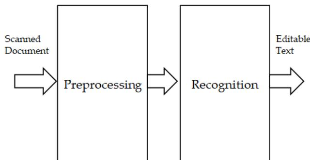
Fig. 1.1.1 OCR Engine
